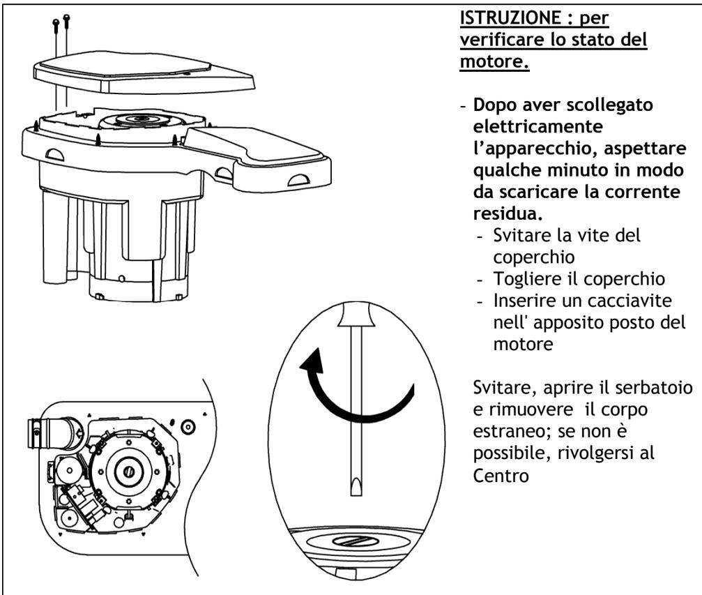
**ISTRUZIONE : per verificare lo stato del motore.**
